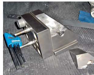
上料工序破损的工具导致生产损失并增加了模具的压力；
