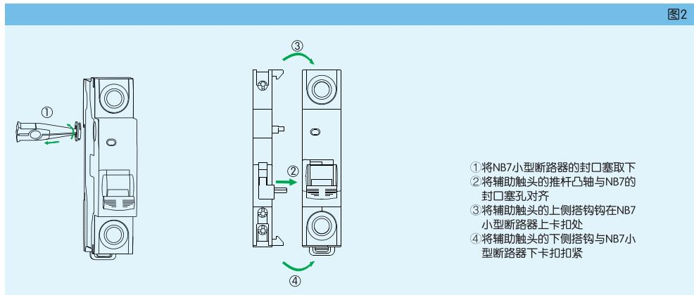
6.2 辅助触头先与小型断路器拼装后, 一起安装在TH35-7.5型钢安装轨上。
