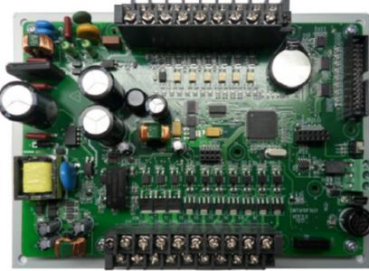
图1 NXXA1410MTAZ 板式PLC外观图
