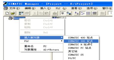
第二步:双击硬件标志进入HW config配置,在HW config配置画面添加MD38PFS.GSD文件,操作如下:
