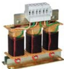
电机电缆大于一定长度时，应在变频器与电机之间插入一个电机电抗器。此最大长度取决于变频器的额定值以及电机电缆的类型。
