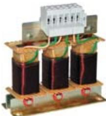
电机电缆大于一定长度时，应在变频器与电机之间插入一个电机进线电抗器。此最大长度决定于变频器的额定值以及电机电缆的类型。
